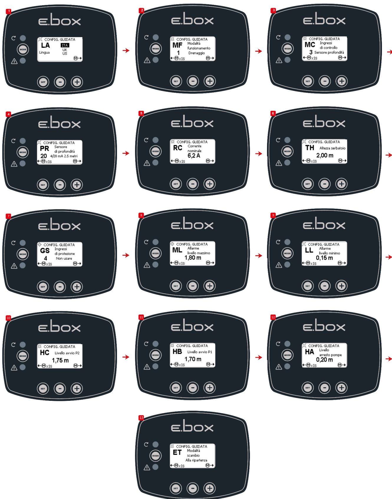
Схема 38: Конфигурация только с датчиком глубины
