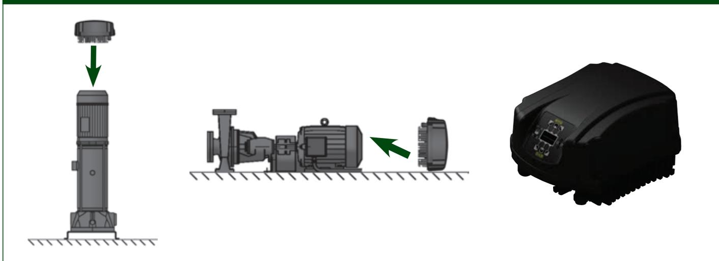
МСЕ монтируется на крышку вентилятора двигателя. Инвертор может работать как в вертикальном, так и в горизонтальном положении. Имеются два комплекта для монтажа на двигатель:
