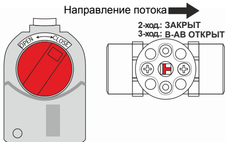
Рис. 4. 2-ход. клапан закрыт / 3-ход. - открыт
