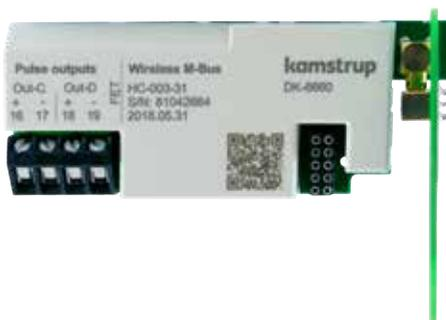
**⚠** Модуль Wireless M-Bus должен подключаться к встроенной или внешней антенне. При монтаже антенны обратите внимание, чтобы ее кабель не перегибался и не зажимался при сборке вычислителя. Перед установкой или замене модулей питание счетчика необходимо отключить, то же касается установки антенны.
